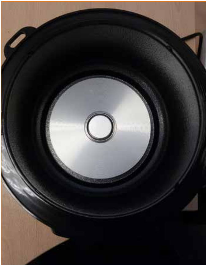
Vnitřek hrnce Multicooker bez vyjímatelné nádoby.
