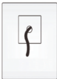
Vyvedený napájecí kabel 2,5–4 mm + 220–240V
